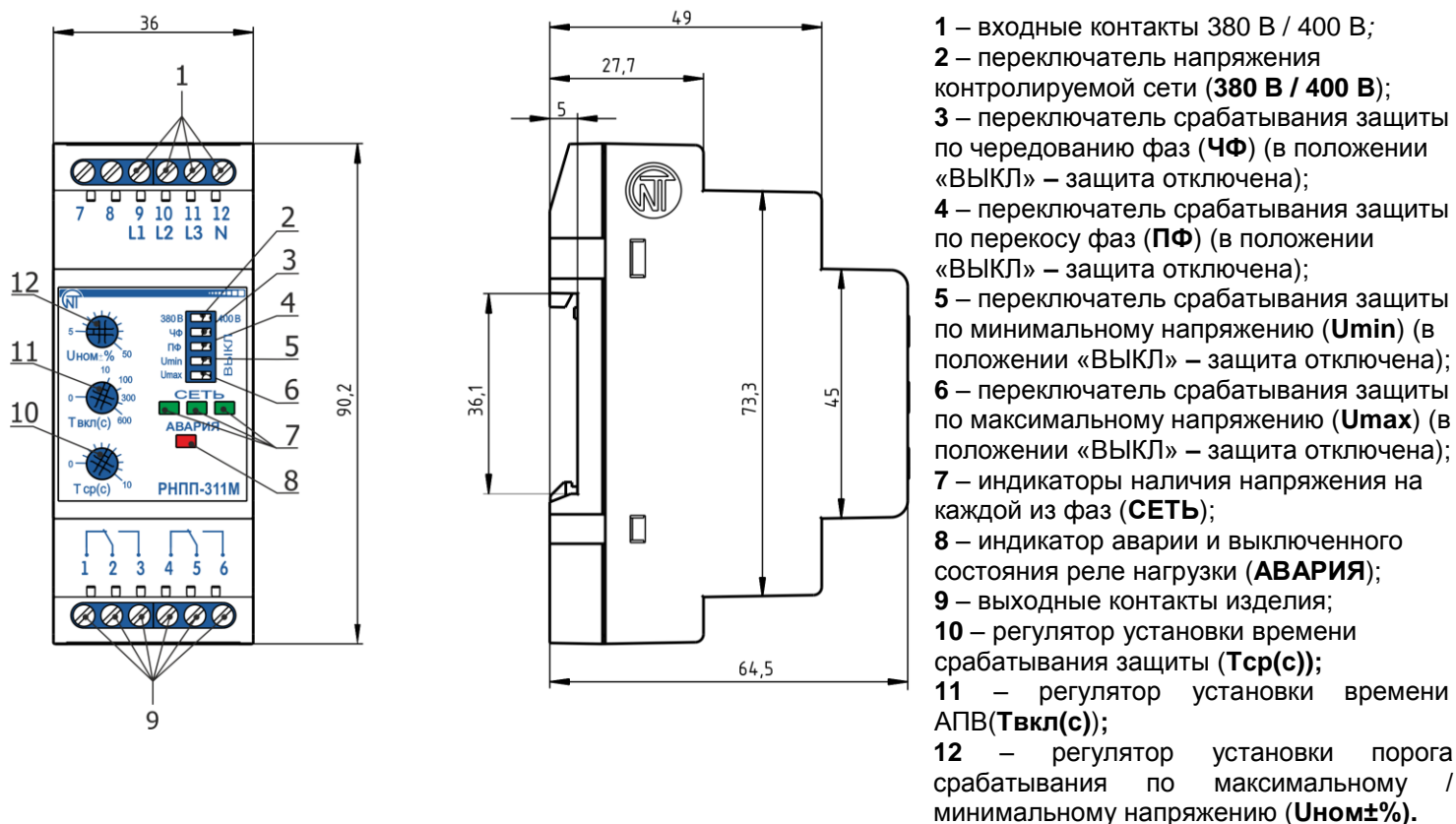
Рисунок 1 – Органы управления, габаритные и установочные размеры РНПП-311М
